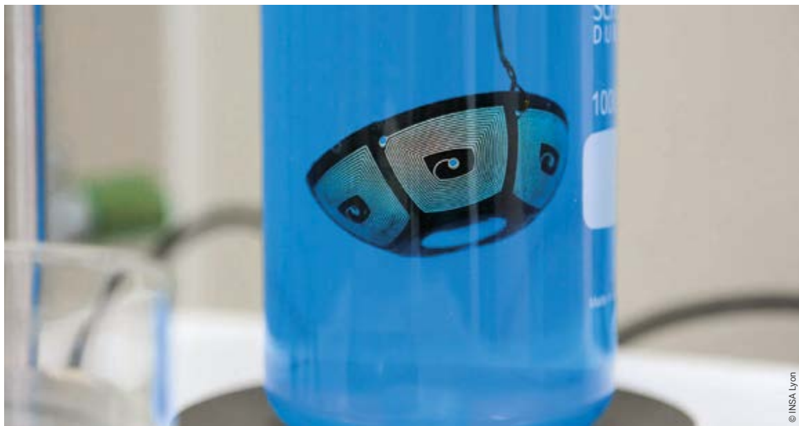
Pièce du capteur inductif multidirectionnel de proximité pour la détection d'approche 3D - Collaboration AMPERE-S2P
